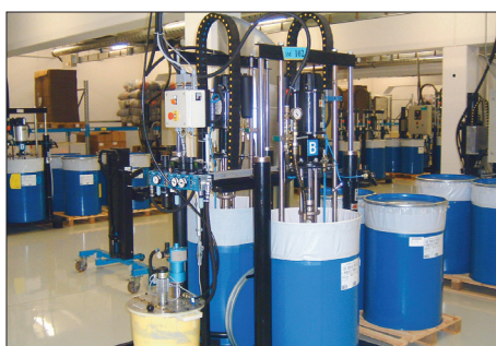
Pompa ekstruzyjna o przełożeniu 23:1 zastosowana w module tłoczenia silikonu
