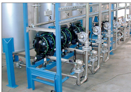
Pompy membranowe 1 1/2" zasilające reaktor w procesie chemicznym
