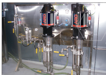
Pompa ekstruzyjna o przełożeniu 23:1 zastosowana w module tłoczenia silikonu
