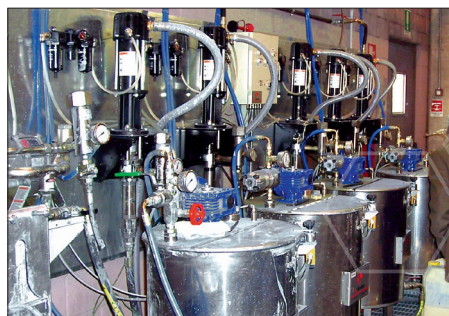
Pompy tłokowe 2-kulowe o przełożeniu 4:1 użyte w procesie wytwarzania farb
