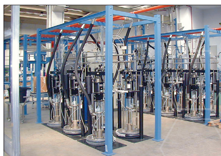
Pompa tłokowa 2-kulowa o przełożeniu 9:1 dostosowana do konkretnego procesu smarowniczego
