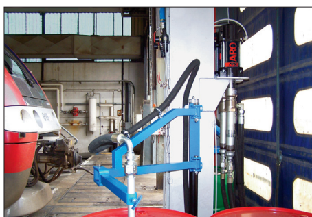
Pompa tłokowa 2-kulowa o przełożeniu 9:1 dostosowana do konkretnego procesu smarowniczego
