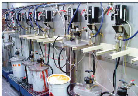
Pompy tłokowe 2-kulowe o przełożeniu 4:1 użyte w procesie wytwarzania farb
