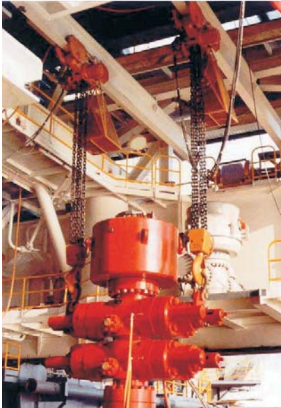
Systemy wciągarek do podnoszenia przewentera (BOP), złożone z dwóch lub czterech wciągarek z wychylnymi wózkami do udźwignięw 4 x 100 ton.
